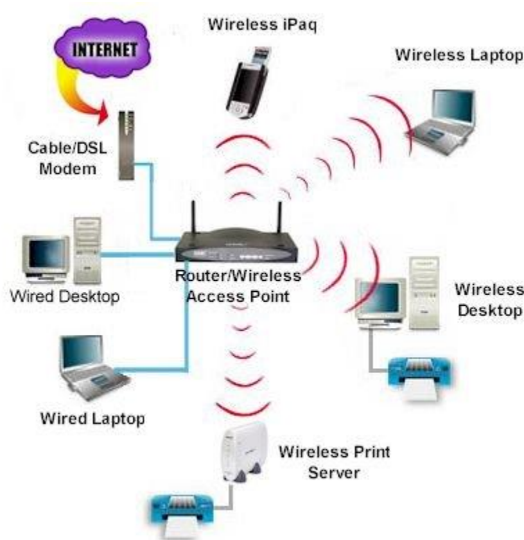
รูป 10.3 การทำงานร่วมกันของ WLAN กับเครือข่ายมีสายรวมทั้งการเชื่อมต่ออินเทอร์เน็ต ที่มา http://www.pchelplosangeles.com/home_networking.htm
