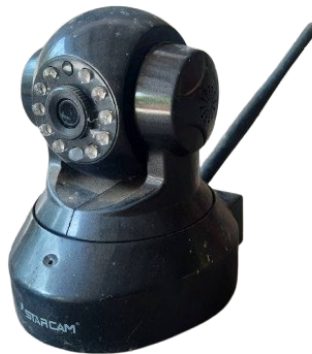
รูปที่ 4.28 สายอากาศกล้องวงจรปิดแบบไร้สาย
