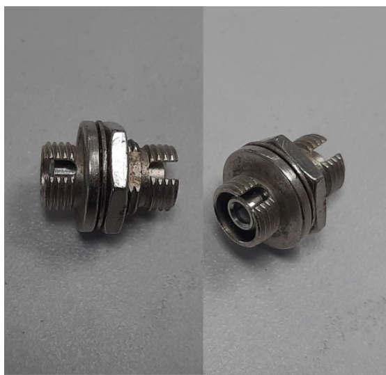
รูปที่ 6.30 ตัวอย่างของ Through Adapter ชนิด FC
