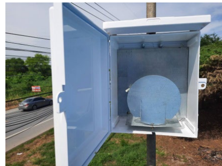
(ข) สายอากาศต้นแบบในกล่องพลาสติก
