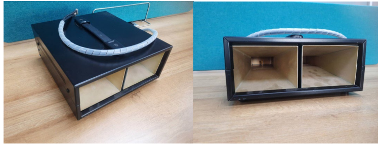
รูปที่ 4.32 สายอากาศแบบท่อนำคลื่นในการตรวจวัดโลหะในผนังปูน
