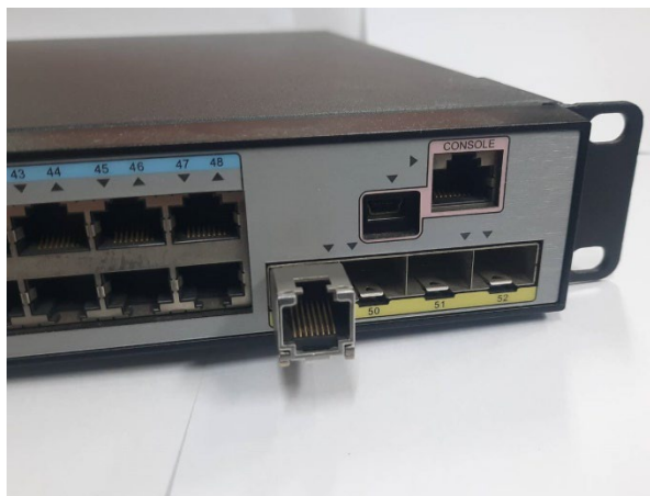
รูปที่ 6.34 ช่องสล็อตของอุปกรณ์ FOM สำหรับเสียบ SFP
