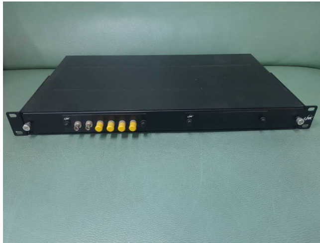
รูปที่ 6.27 ตัวอย่างของ ODF/FDF แบบติดตั้งในตู้อุปกรณ์
