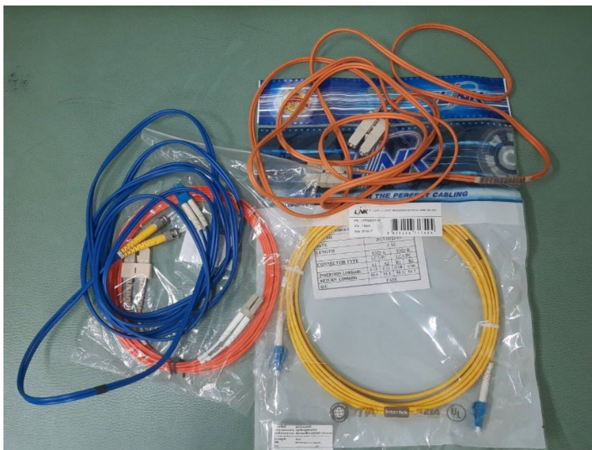
รูปที่ 6.8 ตัวอย่างเส้นใยแก้วนำแสงตามสีเปลือกนอก
