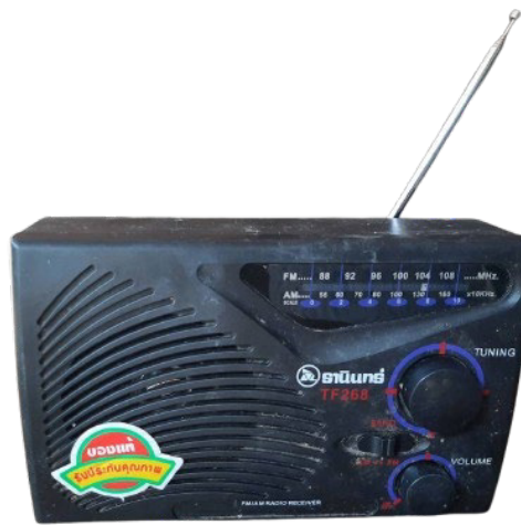
รูปที่ 4.25 สายอากาศแบบเส้นลวดที่ยึดหดได้
